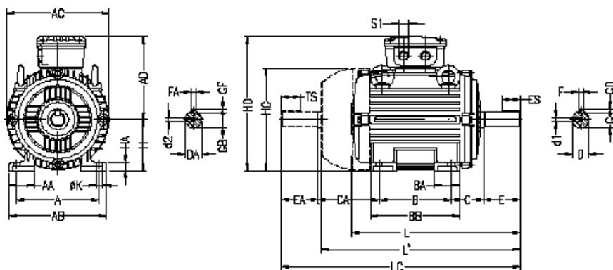
\* Размеры вала даны для II полюсных моторов и только для непосредственного соединения с механизмом.
